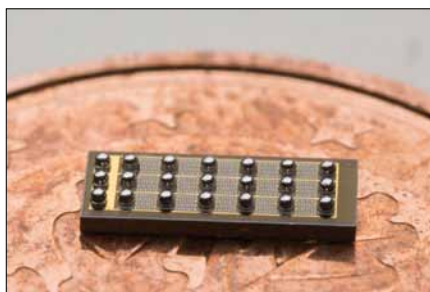
Obr. 1. Nový výkonový tranzistor 25 A 250 V na bázi GaN v porovnání s velikostí mince v hodnotě jednoho eurocentu (foto: FBH/Schurian)
